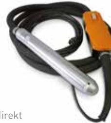
Ausgestattet mit einem kompakten elektronischen Frequenzumformer, der direkt in die Steuerkonsole der Zuleitung integriert ist, eignet sich diese Serie der Innenvibratoren für den Anschluss an 1~ 230V Netzsteckdosen.
