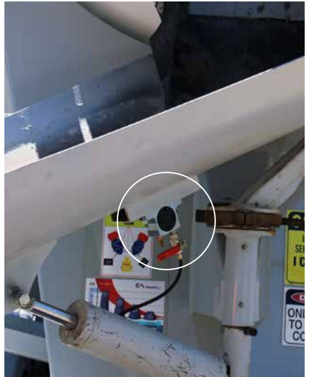
OT (Döner pnömatik vibratör) - Beton mikserinde oluk
