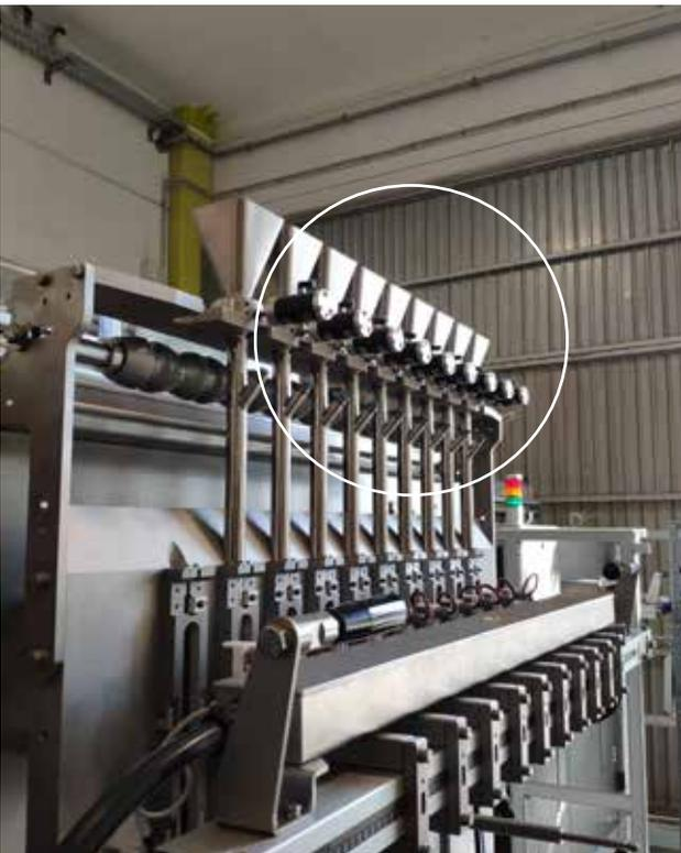
K (pneumatischer Linearvibrator) - Trichterentleerung
