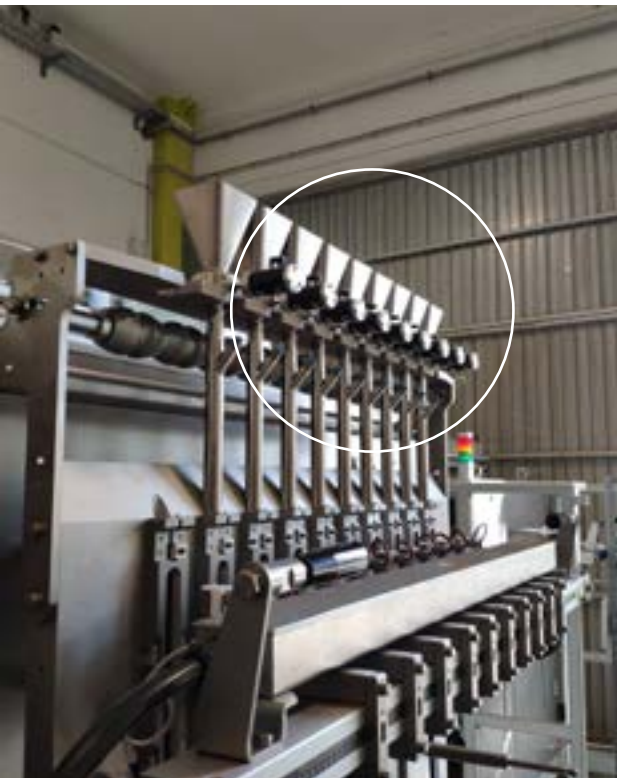
K (pneumatischer Linearvibrator) - Trichterentleerung
