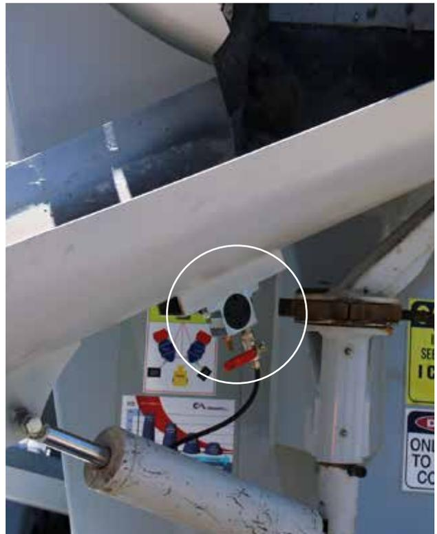
OT (vibrateur pneumatique rotatif) - Goulotte sur bétonnière
