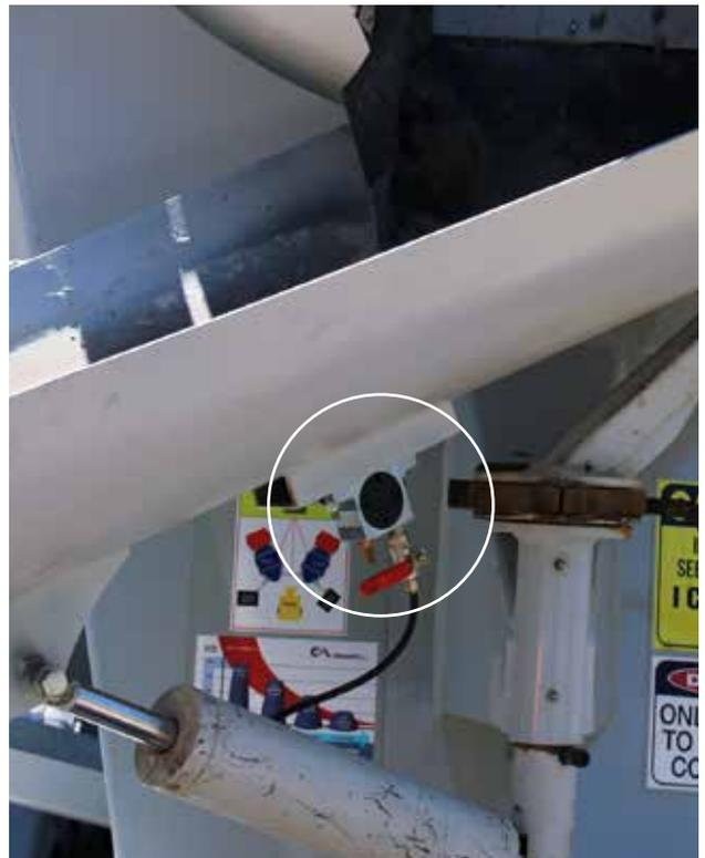
OT (vibratore pneumatico rotativo) - Scivolo su betoniera
