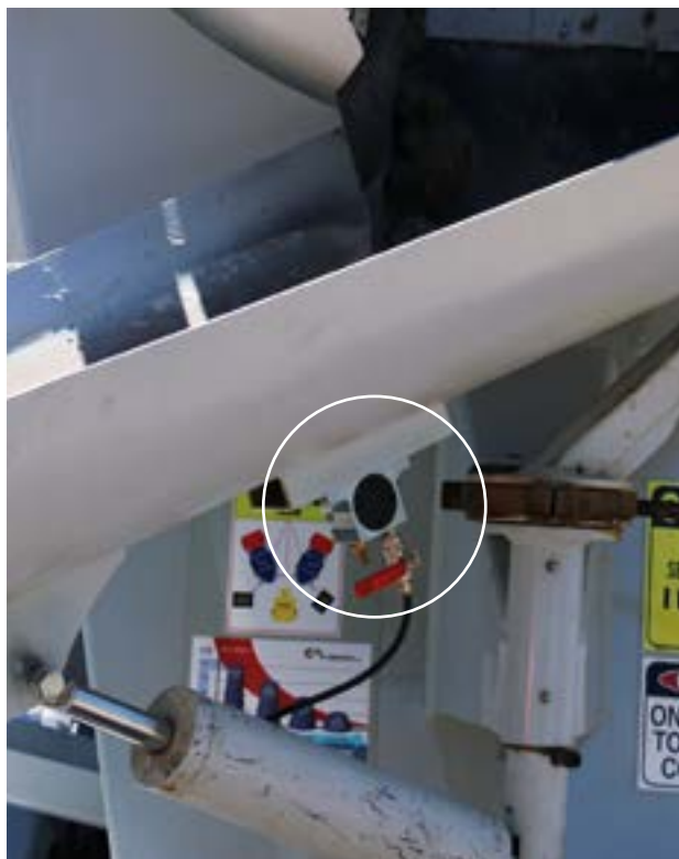
OT (vibratore pneumatico rotativo) - Scivolo su betoniera
