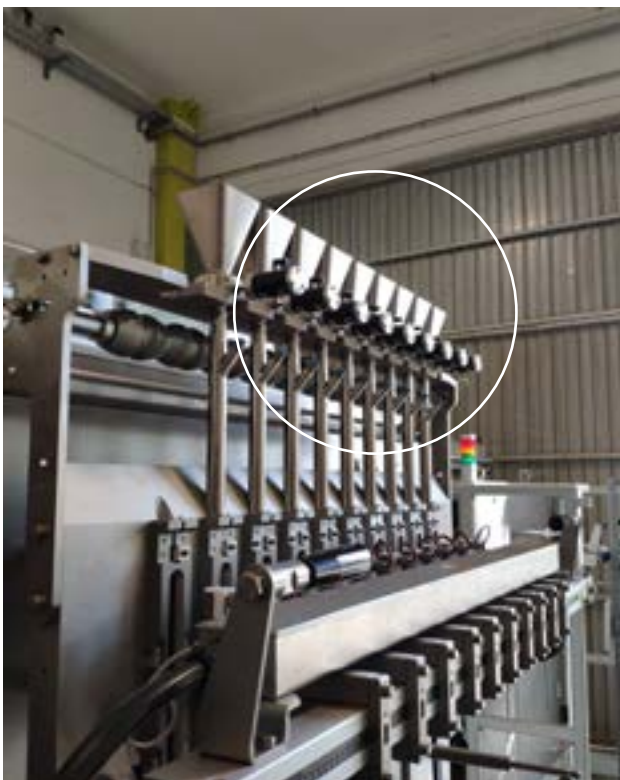
K (vibratore pneumatico lineare) - Svuotamento tramoggia
