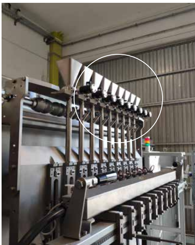
K (vibratore pneumatico lineare) - Svuotamento tramoggia
