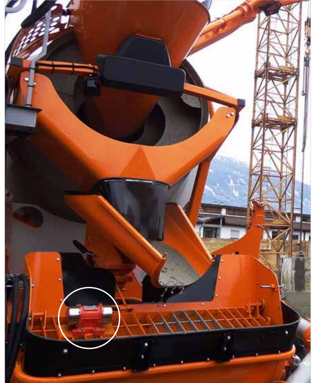
MVE - DC [Vibrador Eléctrico] - Bomba de Concreto
