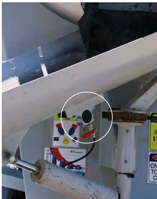
ОТ (роторный пневматический вибратор) - Желоб для бетономесителя.
