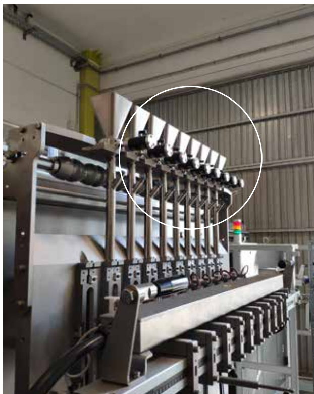
K (liniowy wibrator pneumatyczny) - Opróżnianie zbiornika
