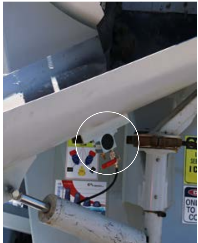
OT (obrotowy wibrator pneumatyczny) - Zsył na betoniarce
