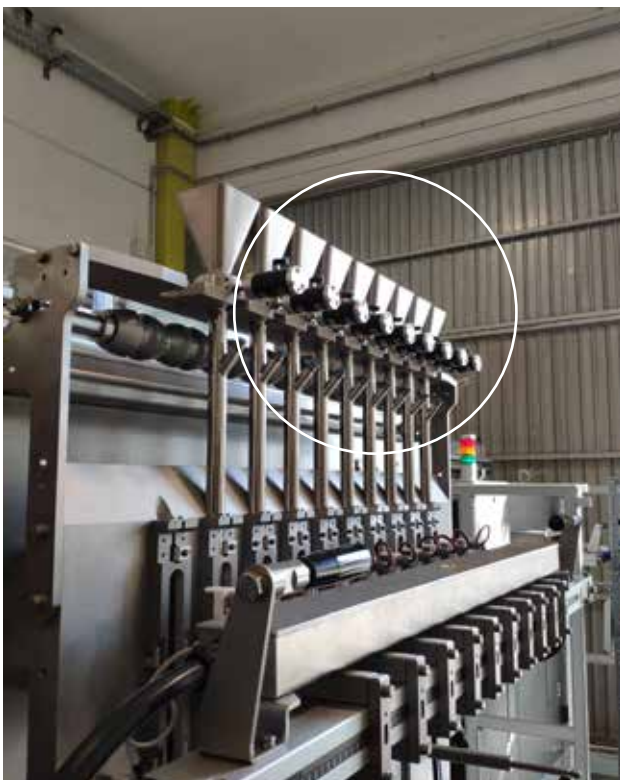
K (liniowy wibrator pneumatyczny) - Opróżnianie zbiornika
