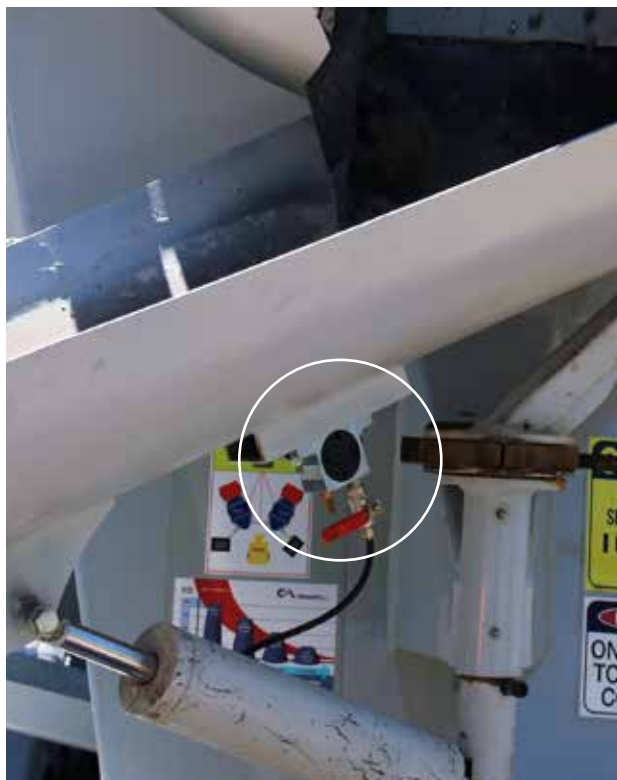
OT (obrotowy wibrator pneumatyczny) - Zsyp na betoniarnie
