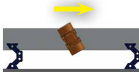
Se as suspensões oscilantes forem montados em uma configuração “suspensa” (tela suspensa, parte vibratória suspensa, ...), as suspensões oscilantes devem ser montadas com o “joelho” virado para trás em comparação à direção de alimentação do material.
