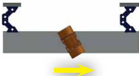
Se a máquina vibratória estiver inclinada com um ângulo superior a 10°, é necessário utilizar o consunto tipo “pantógráfico” em que o “joelho” das suspensões oscilantes estejam com ambos os eixos voltados para a parte externa da máquina. A análise deve ser atingida em comparação com a linha central da máquina. Essa configuração visa preservar a o tempo de vida das suspensões.
